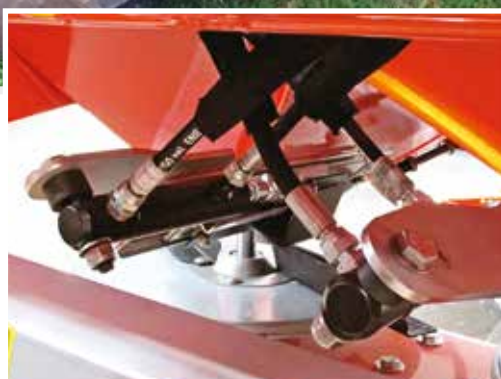
Doppelhydraulische Steuerung mit Doppel-Wirkung
