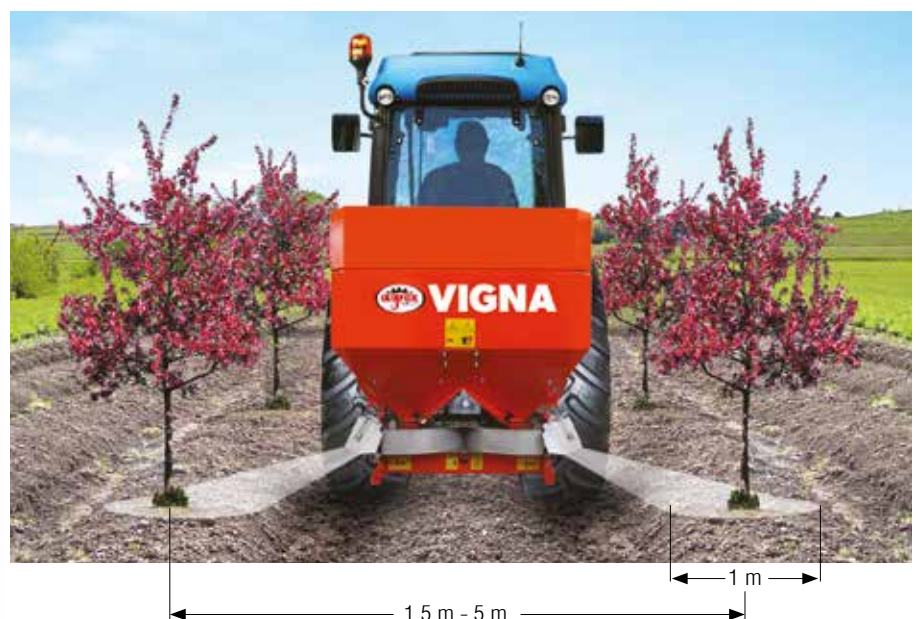
Doppelseitiger schnellabgekuppelter Straufoereder aus Edelstahl
