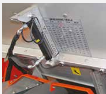
Serranda idraulica del dosatore
