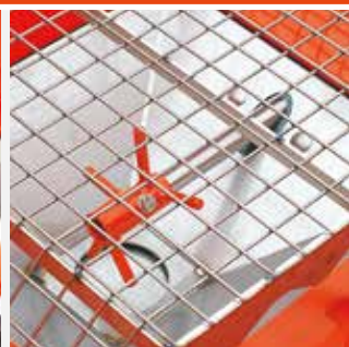
Nirosta Filtergitter aus Edelstahl und langsamen Dreh-Rührwerk
