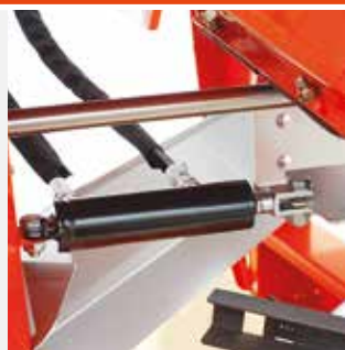
Гидравлический привод для регуливки потока (только на FERTI)
