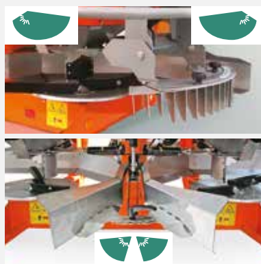
Limitatore mobile per bordure (Sx/Dx/Cen)
