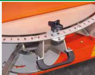
Manuelle Mengenregulierung der Scheibe
