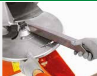
Быстрая регулировка позиционирования лопаток
