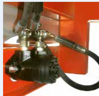
Moteur hydraulique de actionnement disques
