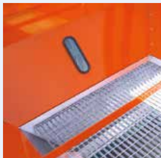
Interno tramoggia con oblò
