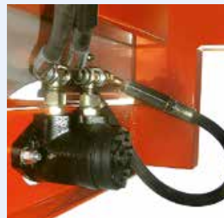
Motore idraulico azionamento dischi
