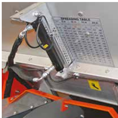
Mando hidráulico de doble efecto dosificador
