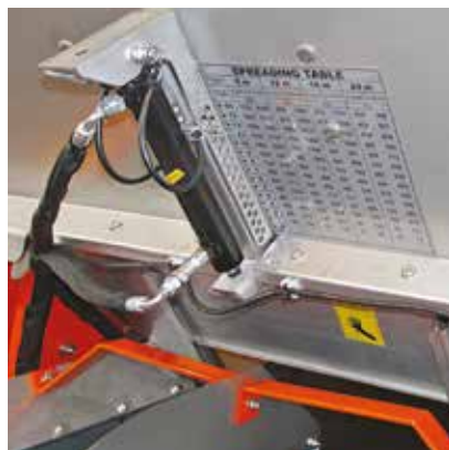
Двойное гидравлическое управление дозатора
