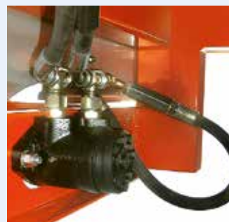
Motor hidráulico accionamiento discos
