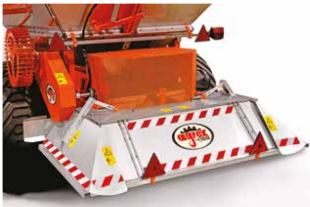
Deflector para esparcir sal y arena en acero inox
