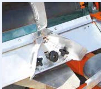
Verteilerguppe aus rostfreiem Stahl
