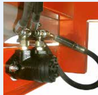
Moteur hydraulique de actionnement disques
