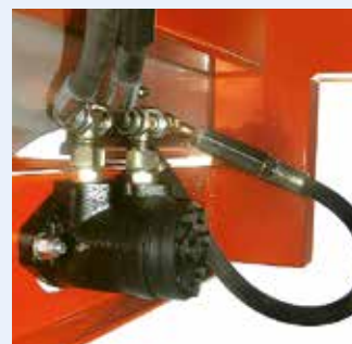
Hydraulischer Antrieb Festplatten
