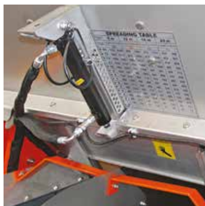
Doppelwirkende Hydraulikkontrolle des Düngerflusses
