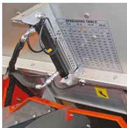
Comando idraulico doppio effetto del dosatore
