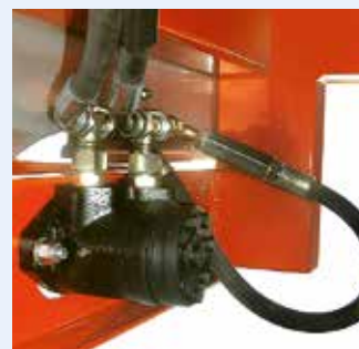
Motor hidráulico accionamiento discos
